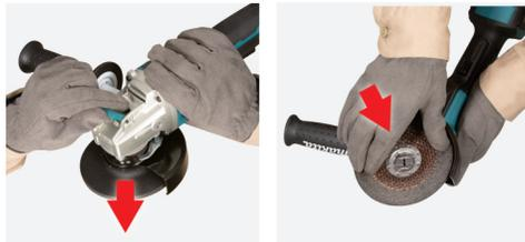
No hay que preocuparse por ninguna pieza perdible. El mecanismo X-LOCK garantiza que el accesorio esté bien montado en la herramienta incluso sin tuerca, brida ni llave.
